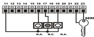
**COLLEGAMENTO LUCE DI CORTESIA 24V**
