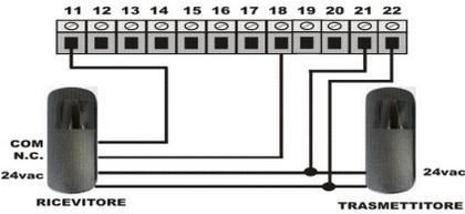
**COLLEGAMENTO FOTOCELLULE «FOTO STOP» IN APERTURA E CHIUSURA**
