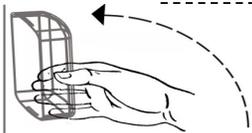
**Apertura fotocellula:** Per aprire la fotocellula svitare la vite posta sul frontale lato destro e sollevare la parte inferiore del coperchio come indicato in figura.
